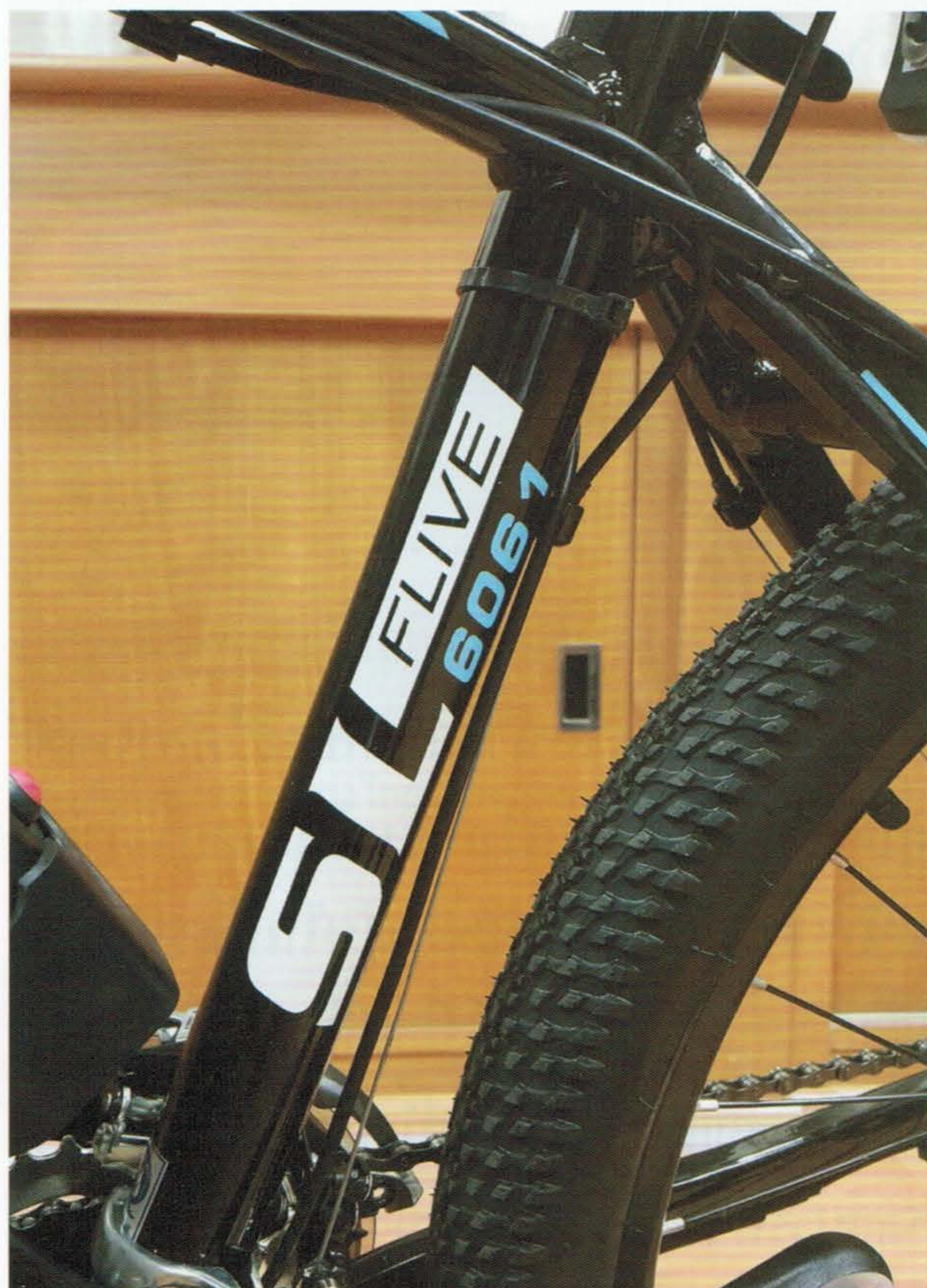
โครงจักรยานทำด้วยอะลูมิเนียม
